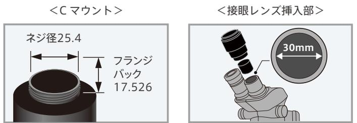
Cマウント (ネジ径 25.4mm フランジバック 17.526mm) もしくは内径 30mm の接眼部へも取り付け可能。(Φ30 スリーブ (別売) 使用)
